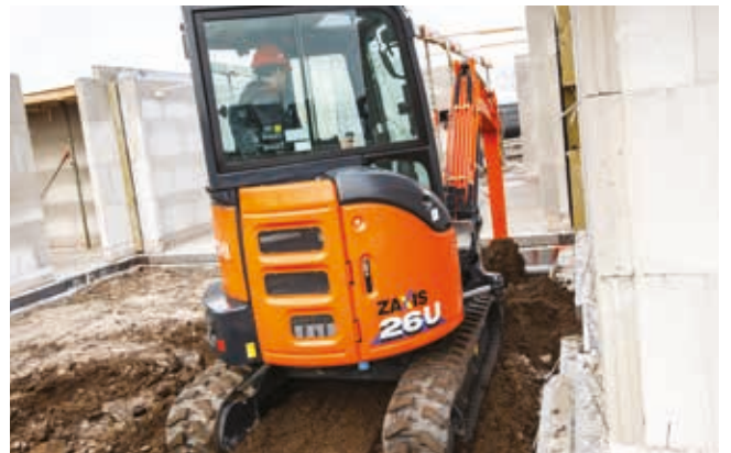
De korte draaicirkel is ideaal voor gebruik in smalle ruimten.
