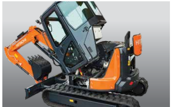
De kantelbare cabine zorgt voor eenvoudige toegang tot de motor en ventilatieblok, zodat servicewerkzaamheden snel kunnen worden uitgevoerd.
