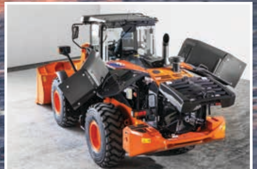
Gemakkelijke toegang voor onderhoud vanaf de grond.
