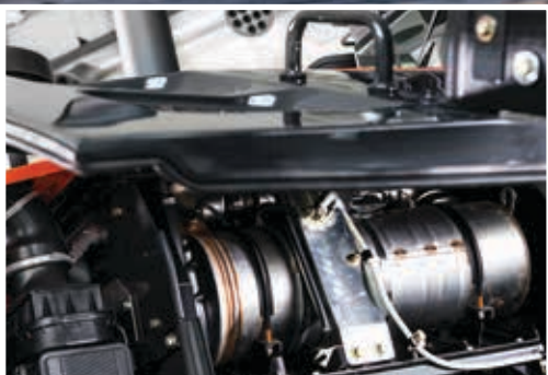
Het SCR-systeem verlaagt de emissies.
