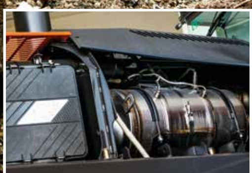
Het SCR-systeem vermindert de uitstoot en brengt het geluidsniveau omlaag.
