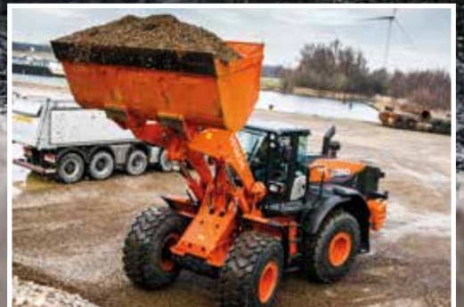
De flow control van de hydrauliek zorgt voor de gelijkmatige beweging van de hefarm.
