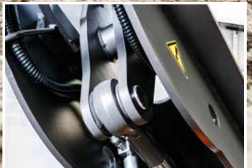
De slangen en bedrading zijn in de enkelvoudige arm ondergebracht om belangrijke componenten te beschermen.
