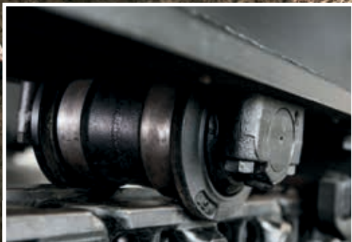
Opnieuw ontworpen onderste roller voorkomt dat er modder tussen komt en schade veroorzaakt.
