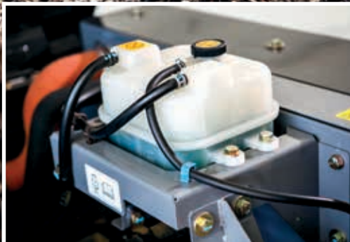
De expansietank voorkomt oververhitting van motoronderdelen.
