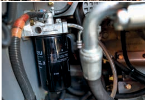
Vervanging van het brandstofhoofdfilter is gemakkelijker geworden.
