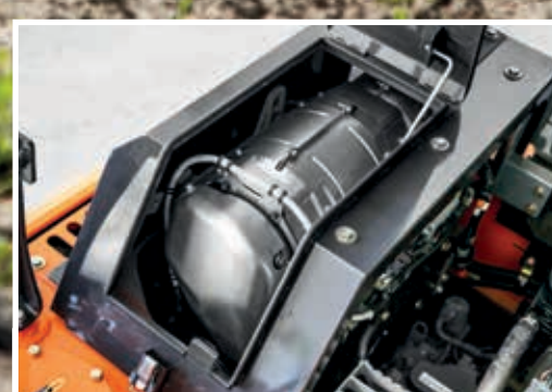
Het SCR-systeem vermindert uitstoot en brengt het geluidsniveau omlaag.
