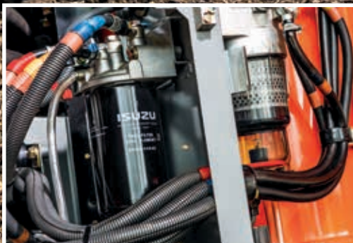
Vervanging van het brandstofhoofdfilter is gemakkelijker geworden.
