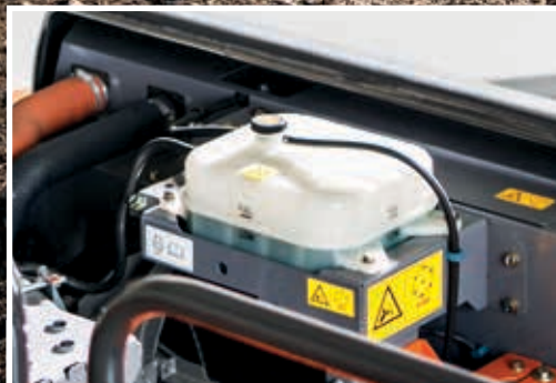
De expansietank voorkomt oververhitting van motoronderdelen.
