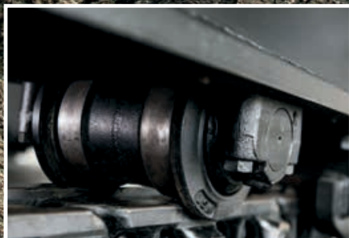
Opnieuw ontworpen onderste roller voorkomt dat er modder tussen komt en schade veroorzaakt.
