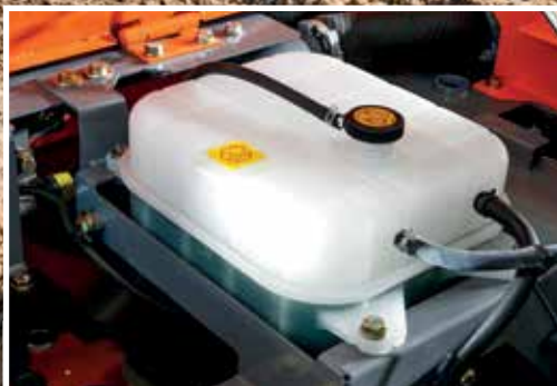
De expansietank voorkomt oververhitting van motoronderdelen.
