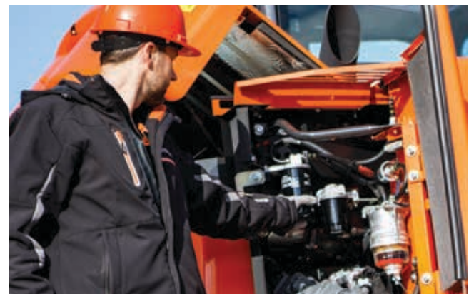
De dagelijkse inspectiepunten zijn voor het gemak bij elkaar geplaatst.
