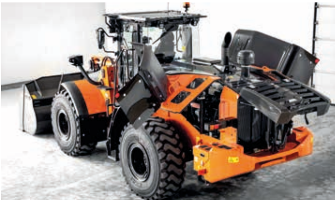
De motorkap biedt een comfortabele toegang voor dagelijkse inspecties.
