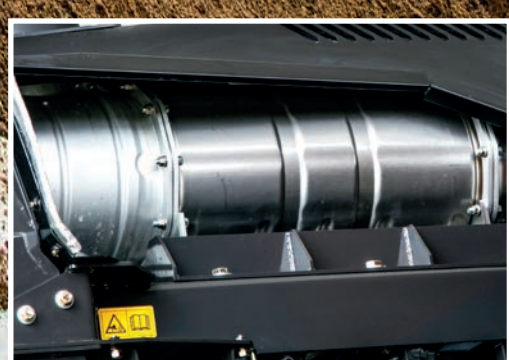
Het SCR-systeem vermindert de uitstoot en brengt het geluidsniveau omlaag.
