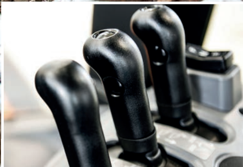
De Powerboostschakelaar vergroot het vermogen wanneer het nodig is.
