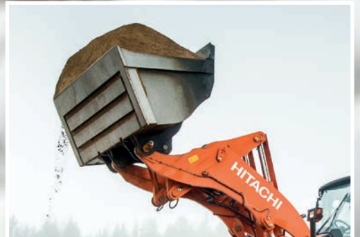
De flow control van de hydrauliek zorgt voor de gelijkmatige beweging van het hefframe.
