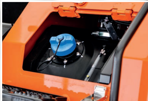
Er wordt adBlue® in de uitlaatgassen geïnjecteerd zodat de uitstoot vermindert.
