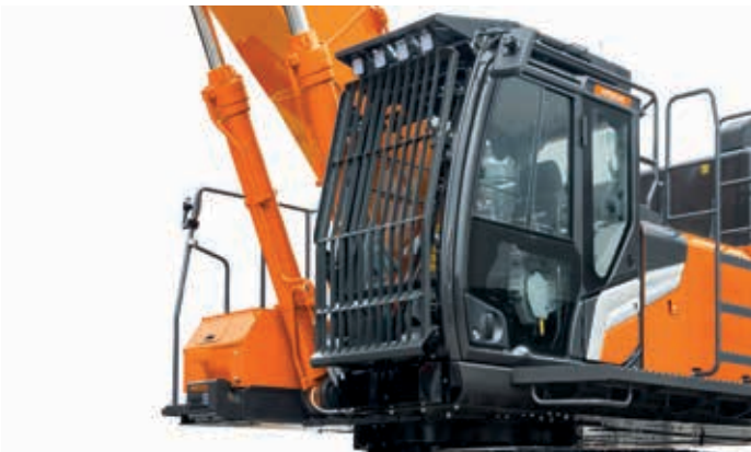
De ZX530LCH-7 beschikt over bescherming voor de voorruit en het dak, alsook vier cabinelampen.
