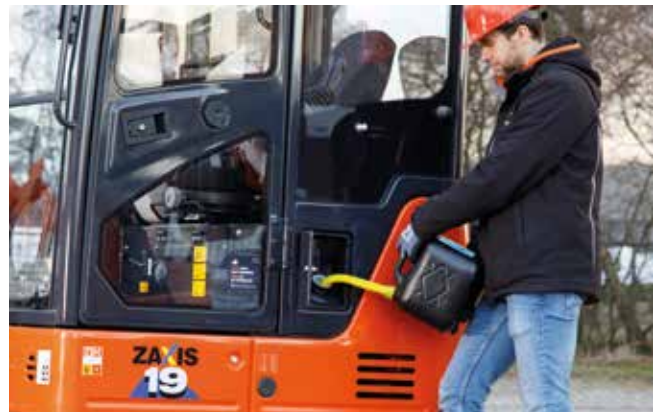
De verplaatste opening van de brandstoftank zorgt dat tanken heel eenvoudig is.
