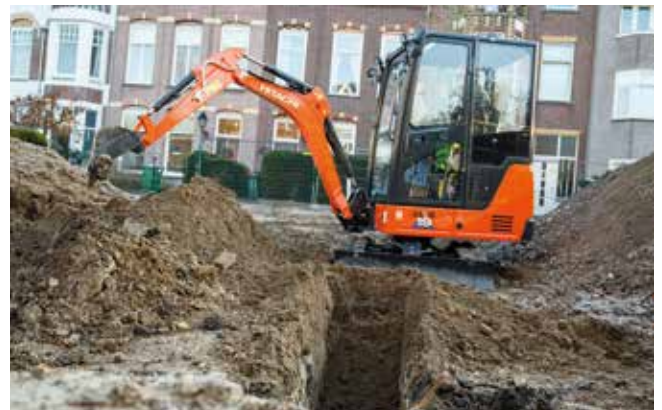
De boomcilinder is aan de bovenzijde van de boom geplaatst, voor bescherming tegen schade.
