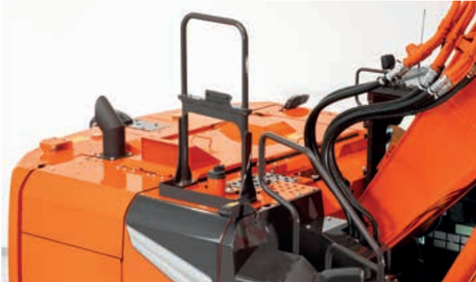
De nieuwe handreling op de ZX225US/USR-7 is inschuifbaar voor probleemloos transport.
