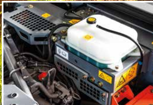
De expansietank voorkomt oververhitting van motoronderdelen.
