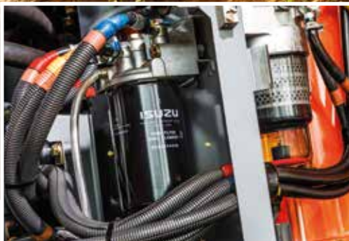
Vervanging van het brandstofhoofdfilter is gemakkelijker geworden.
