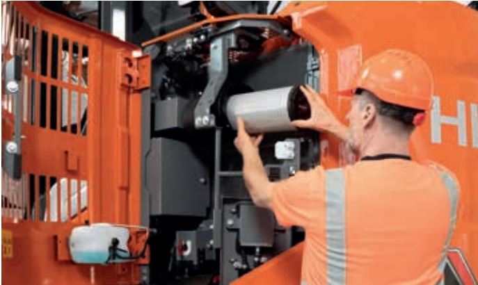
Toegang tot filters is verbeterd in de ZX135US-7.
