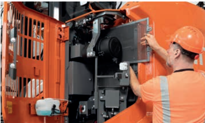
Vergrote radiateurdeur (ZX135US-7) biedt eenvoudig toegang voor reiniging en onderhoud.
