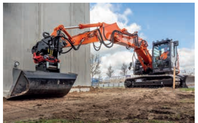
Het ondersteuningssysteem voor uitrustingsstukken vergroot de veelzijdigheid.
