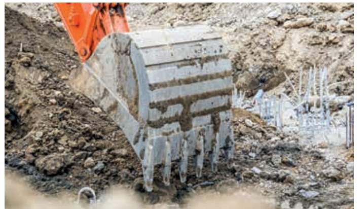
Hitachi-graafwerktuigen omvatten zelfslijpende tanden en betrouwbare adapters, zodat ze precies op de machines passen.
